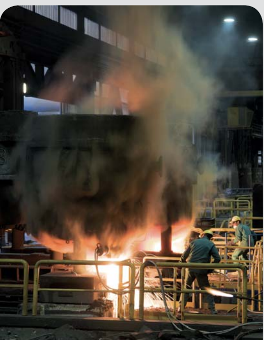
Cividale del Friuli | Sivere in fase di colata di acciaio liquido
