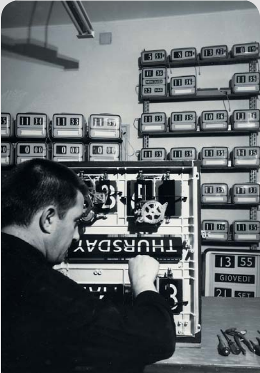
Udine | Solari. Fasi di montaggio degli orologi a "palette" invenzione che ha reso celebre il marchio nel mondo
