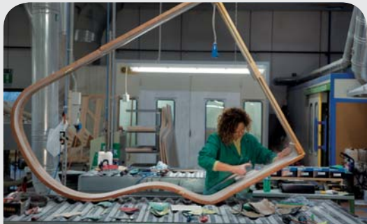
Sacile | Pianoforti Fazioli. Fase di carteggiatura dell'interno della fascia del mobile
